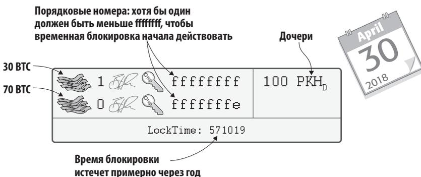
**Рис. 9.4.** Временная блокировка транзакции с использованием высоты блока. Эта транзакция впервые станет действительной в блоке с высотой 571020
