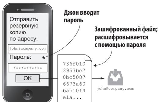
**Рис. 4.6.** Джон создает резервную копию своих закрытых ключей. Они записываются в файл, который затем шифруется паролем, который Джон вводит на своем телефоне
