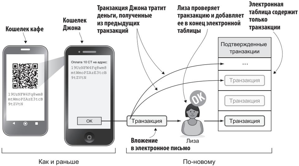
Транзакции имеют входы и выходы. Выход транзакции содержит последнюю часть программы на языке Script. Вход транзакции, расходующей этот выход, должен включать первую часть программы.
