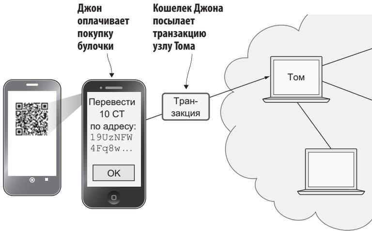
Рис. 8.11. Транзакция отправляется узлу Тома через TCP-соединение
