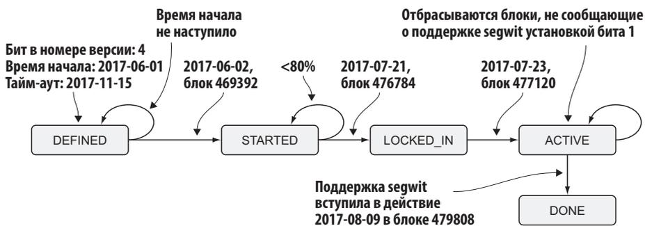
**Рис. 11.25.** Состояние развертывания VIP91 обновляется через каждые 336, а не через обычные 2016 блоков. Оно прошло очень быстро
