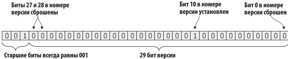
**Рис. 11.21.** Номер версии блока интерпретируется по-разному. Каждый из 29 битов справа может сигнализировать о поддержке разных предложений
